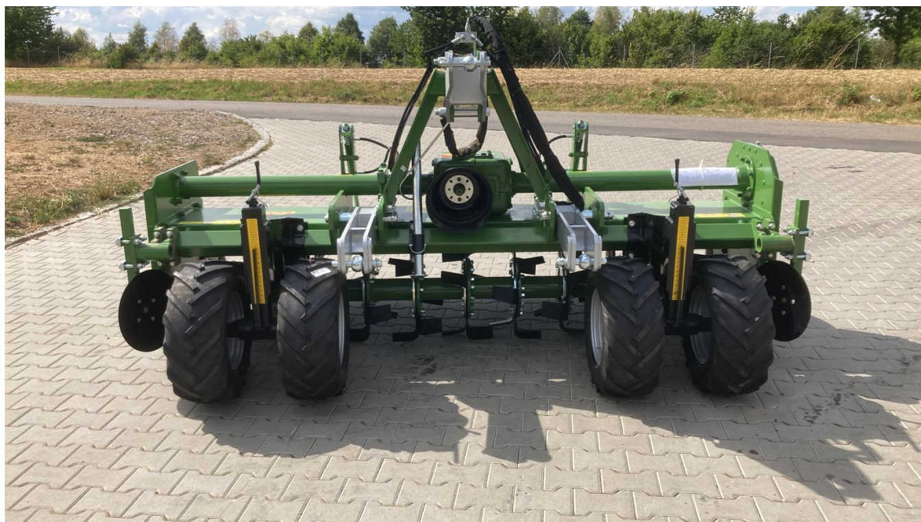
Abbildung: Biofräse Tiger 190-280, Arbeitsbreite: ca. 2,85m, Maschinenbreite: ca. 3,00m
