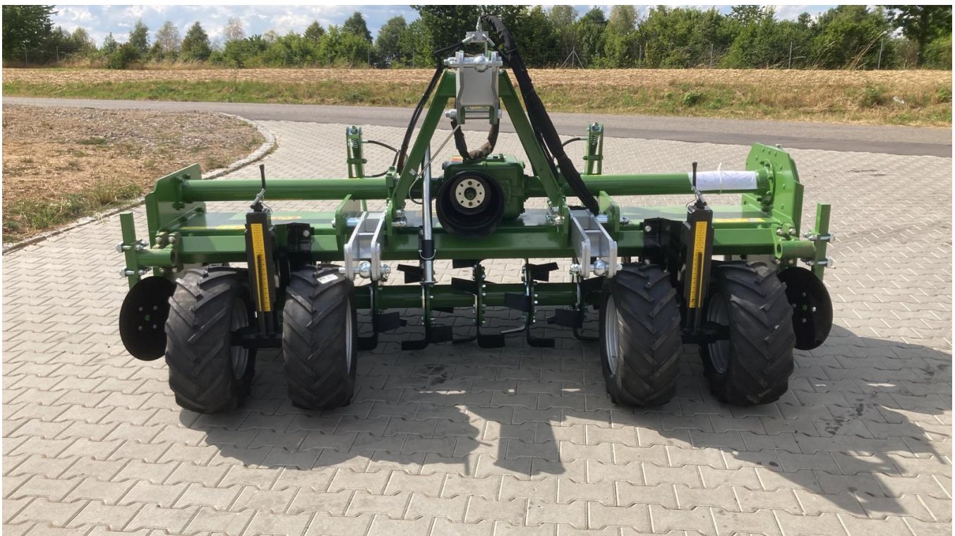
Abbildung: Biofräse Tiger 190-280, Arbeitsbreite: ca. 2,85m, Maschinenbreite: ca. 3,00m
